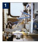
Das Leimauftragen verläuft so, dass eine Einschub-Einrichtung jede Lamelle einzeln in die Leimmaschine schiebt, wo mehrere Rollen die Lamellen unter die Leimdüse ziehen und führen (beim Einsatz von einem Zwei-Komponentenkleber kann eine Härterdüse hinzugefügt werden).
