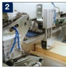
Nach der Leimauftragung werden die Lamellen über Riemenbahnen in einen Aufrichter quergeführt, wo sie auf Hochkant gestellt werden – und weiter in ein Magazin, wo sie gesammelt werden. Die Riemenbahnen gewährleisten eine so ruhige und gleichmäßige Querführung wie möglich.
