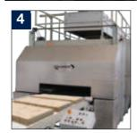
Die Hochfrequenzpresse ist mit einem zuverlässigen Hochleistungsgenerator ausgestattet, der sehr kurze Presszeiten gewährleistet.
