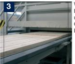
Wenn das Magazin gefüllt ist, werden die gesammelten Lamellen auf den Einlegetisch unter dem Magazin gesenkt und ausgerichtet.
