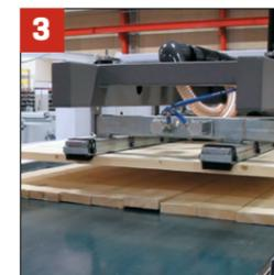
Der Block fährt rückwärts unter den Vakuumheber, wo die Querlamellen hinzugefügt werden. Zwischen jede Schicht wird Kleber mit Hilfe einer Flächengießmaschine in voller Breite aufgetragen.
