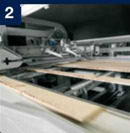
**2** Kleber wird auf die Kante der Schwarte aufgetragen. Nach der Leimauftragung werden die Lamellen quer in ein Magazin befördert, in dem sie zu einem Paket gesammelt werden.
