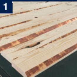
**1** Das System ist in der Lage, die Schräge der konischen Schwarten zu messen und daraus zu entscheiden, ob das Holz gedreht werden soll - um am Ende eine ungefähr gerade Platte zu erhalten. Das Holz wird nach seiner konischen Form in vier Ebenen sortiert. Das System berechnet, in welcher Reihenfolge das sortierte Holz zur Leimauftragung geleitet wird.
