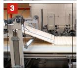
Die vollautomatische Presse hat von der oberen Druckplatte einen Lamellierdruck von 10 kg/cm2. Dieser Druck wird von kräftigen Hydraulikzylindern erzeugt. Alle Zylinder können einzeln abgesperrt werden und ermöglichen so die genaue Anpassung des Druckmusters an die Form des Elements, beispielsweise über Löcher für Fenster und Türen
