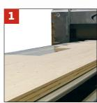
Bevor das BSP-Element in die Presse geleitet wird, wird es geformt und in der gewünschten Schichtzahl auf eine Kunststoffplatte aufgelegt. Zwischen jede Schicht wird Kleber aufgetragen.
