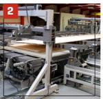
Die BSP-Elemente werden in die Presse geschoben – Elemente über 4 Meter werden stufenweise gepresst.
