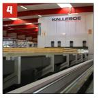
Nach beendetem Presszyklus werden die Elemente auf den Auslauftisch geschoben. Der Druckwagen dieses Tisches fährt über die Elemente hinweg und schiebt es/sie zur weiteren Verarbeitung vorwärts.
