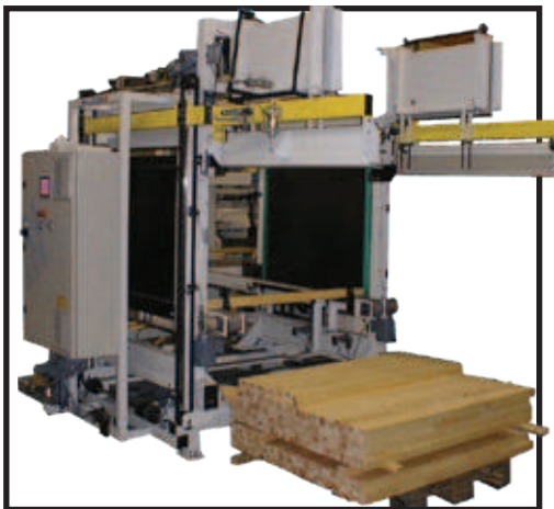
Abstapler für das automatische Abstapeln der Werk- stücke von Paletten
